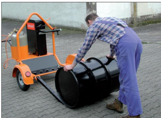
Das Fass wird einfach über die Rungen auf die Maschine gerollt. Hierbei sorgt die Klotzfallbremse dafür, dass die Maschine nicht weglieft.
