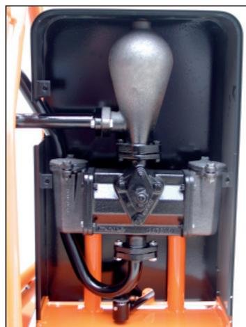
Die doppelt wirkende MAUS® Spezial-Kaltbindemittel-Pumpe, welche unter einem Wärmekasten montiert ist, kann mittels Propangasbrenner erwärmt werden, so dass es auch bei kühler Witterung möglich ist, Kaltbindemittel zu verspritzen.
