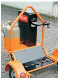
Zu diesem Typ kann eine Fassanwärmevorrichtung, Brenner mit Piezozündung und thermoelektrischer Züandsicherung und Flammüberwachung, geliefert werden, mit der es möglich ist, besonders zähflüssige Bindemittel auf ca. 35-40 Grad zu erwärmen und somit einwandfrei zu verarbeiten.
