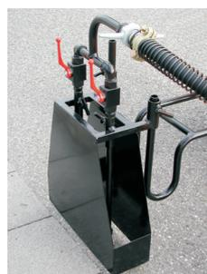
Um ein Verschmutzen des Randsteines zu vermeiden, haben wir eine höhenverstellbare Kantenspritzvorrichtung mit Spezialdüsen entwickelt. Dieses Gerät wird seitlich an unseren Maschinen angebracht und garantiert einwandfreie Kantenspritzungen.
