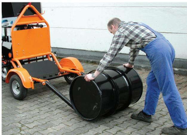
Das Fass wird über die Rungen auf die Maschine gerollt. Hierbei sorgt die Feststellbremse dafür, dass die Maschine nicht wegrollt.
