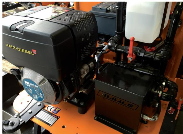
Die beheizte MAUS® Spezial-Kaltbindemittel-Pumpe wird mit einem 5,0 KW HATZ-Dieselmotor mit Elektrostart hydraulisch angetrieben.
