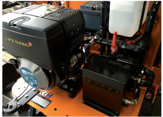
Die beheizte MAUS® Spezial-Kaltbindemittel-Pumpe wird mit einem 5,0 KW HATZ-Dieselmotor mit Elektrostart hydraulisch angetrieben.
